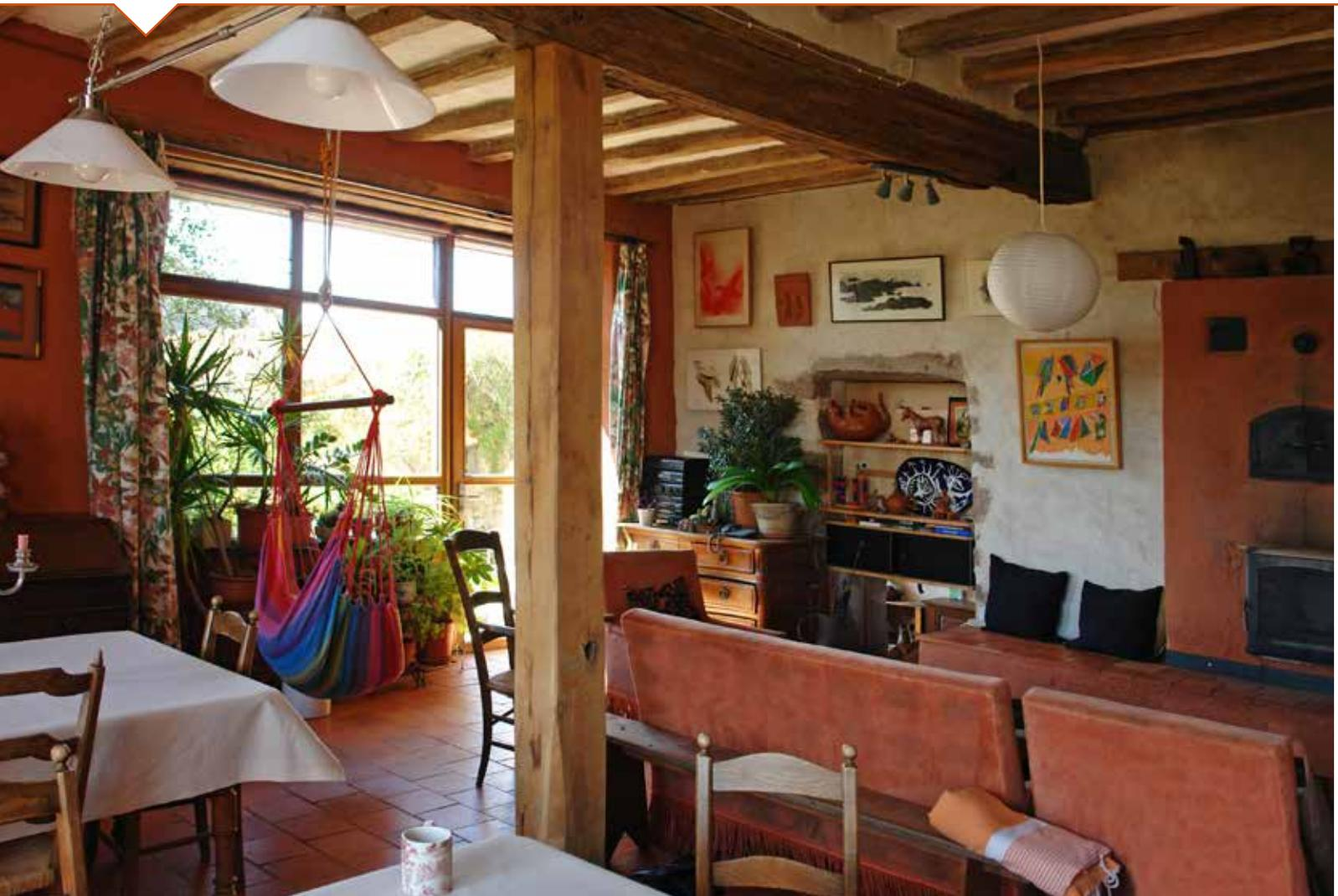
*Le séjour a pu être ouvert en repositionnant des poutres à la place des murs porteurs. Ces poutres s'appuient sur le haut de la voûte de la cave. Également tables d'hôtes, le lieu est chaleureux et lumineux.*
